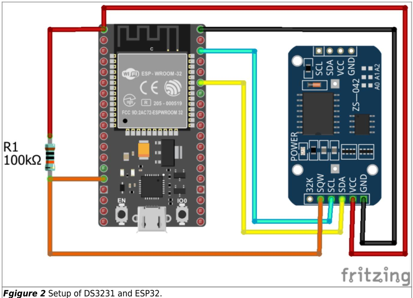
**Figure 2** Setup of DS3231 and ESP32.
