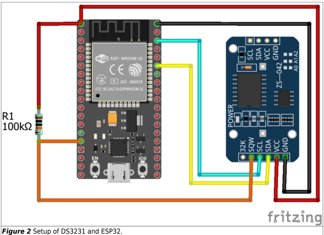
**Figure 2** Setup of DS3231 and ESP32.
