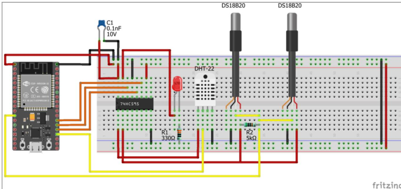
**Figure 3** ESP32 connected with DHT-22, DS18B20 and SN74HC595.
