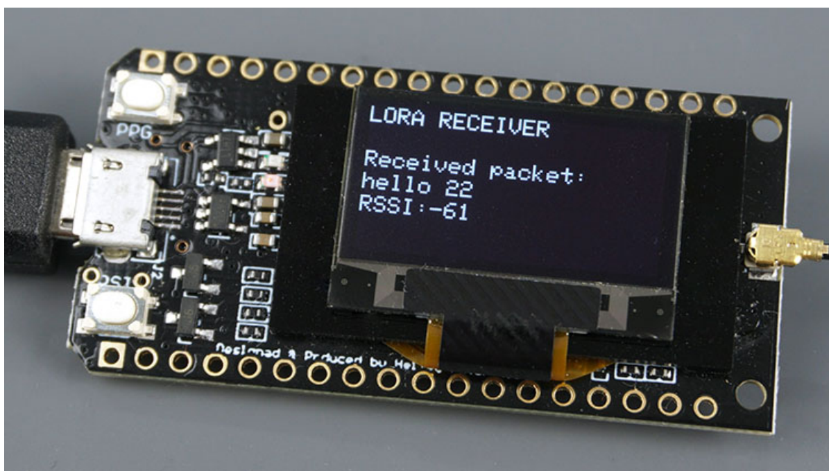
Fig.: TTGO LoRa32 OLED V1 .
