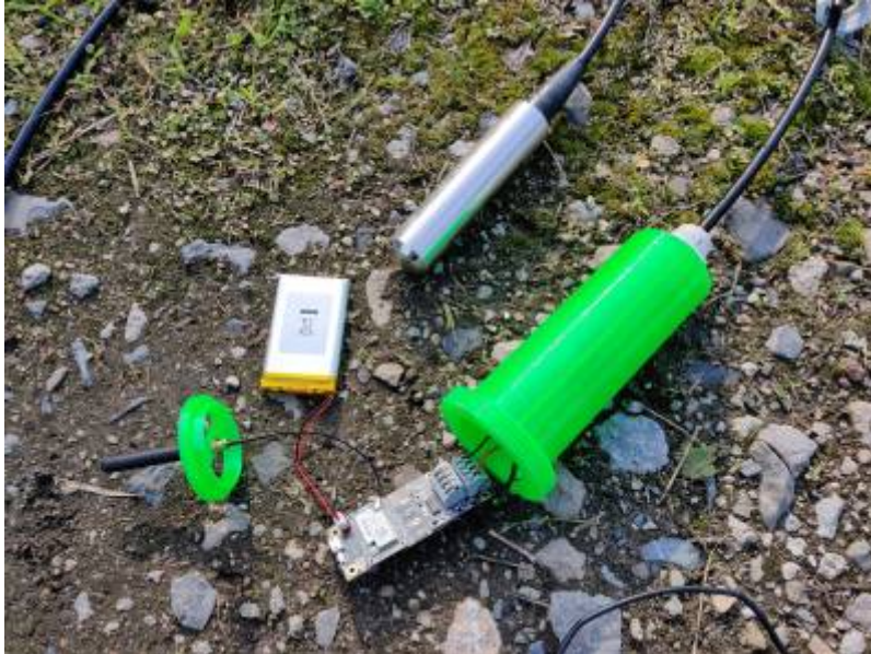
Fig. 4: Rak 4630 Board mit Batterie
