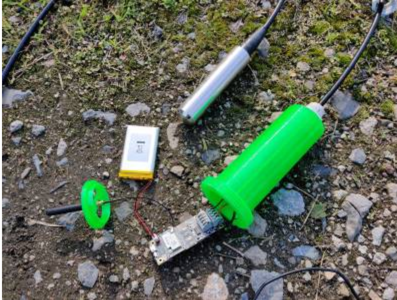
Fig. 4: Rak 4630 Board mit Batterie
