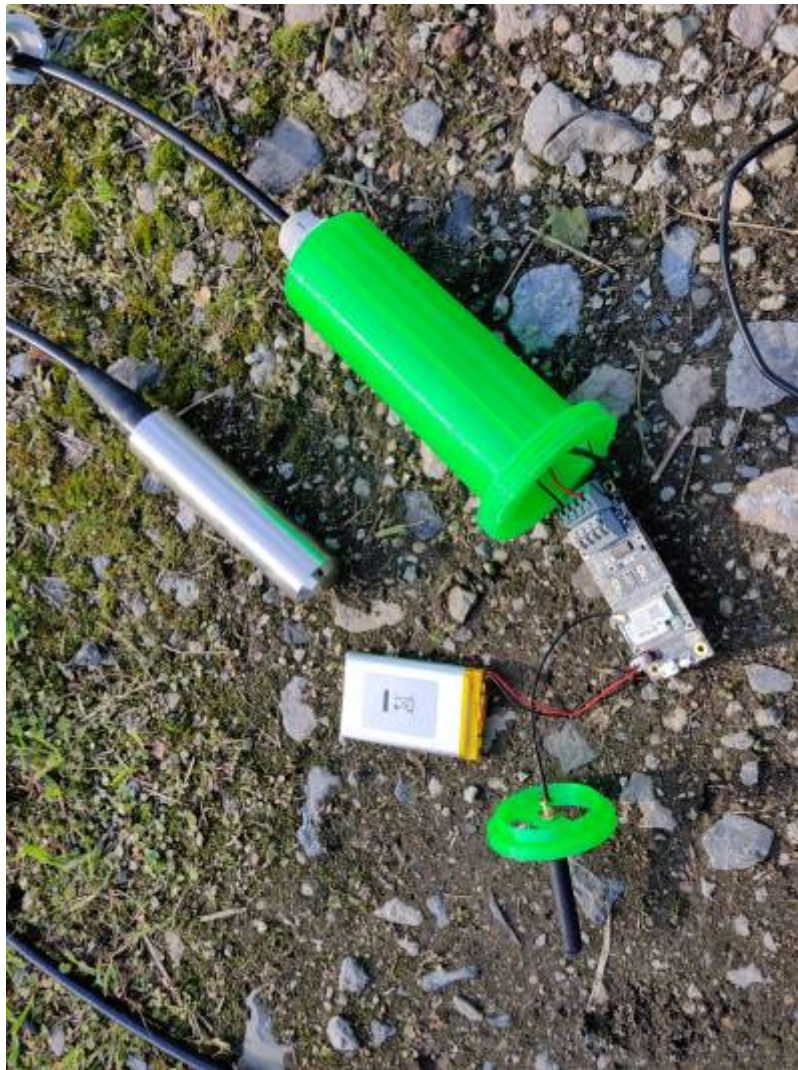
Fig. 4: Rak 4630 Board mit Batterie
