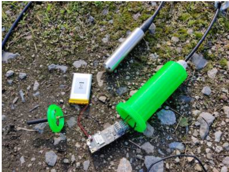
Fig. 4: Rak 4630 Board mit Batterie
