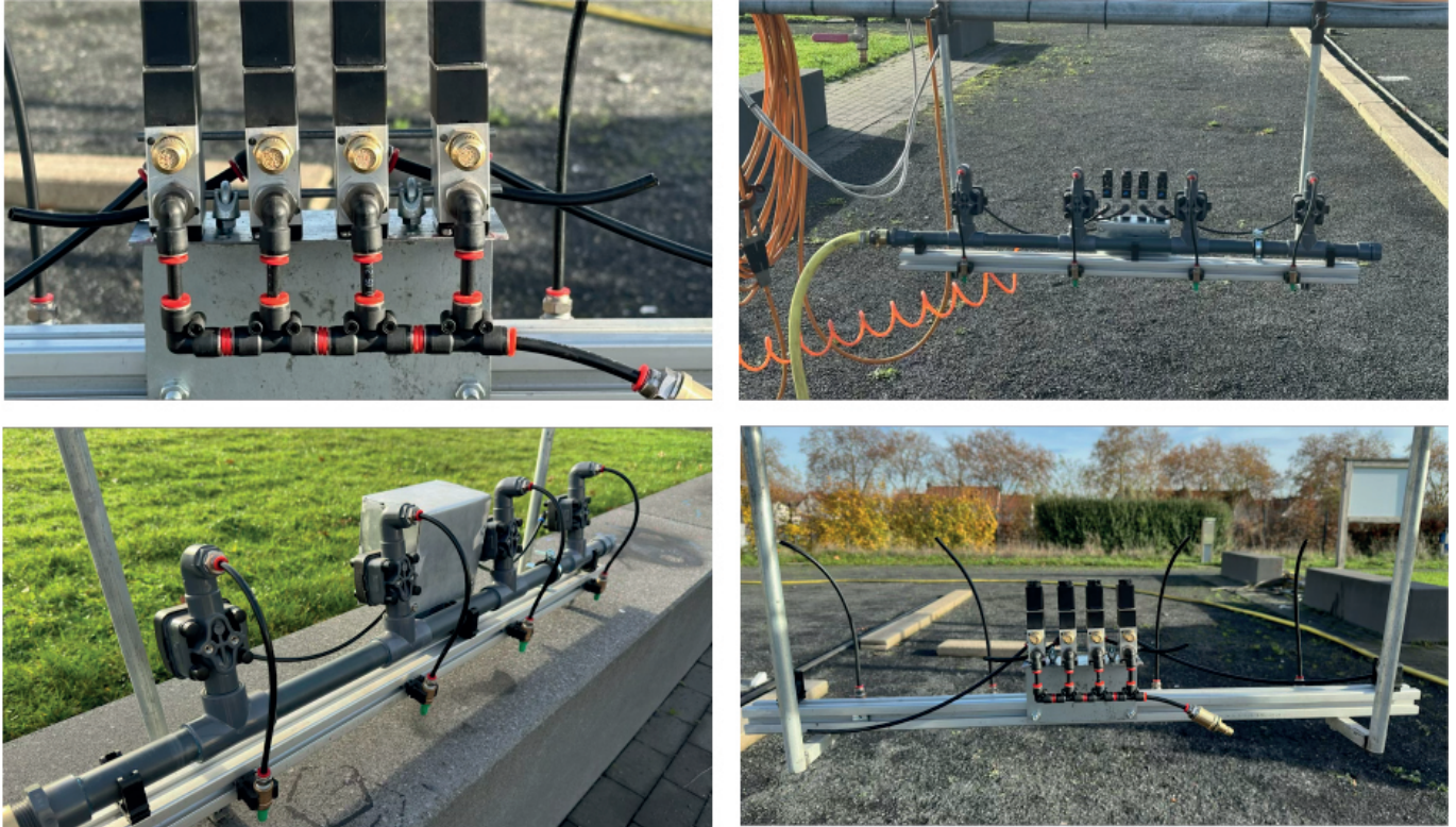
Fig. 5: Aufrüstung des Gießwagen mit einem Pneumatik Arm
