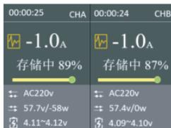
3) 当两组电池电压一高一低于存储电压时，高压的电池进行放电保养，低压的电池进行充电保养。(如右图)
